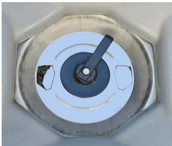
Um agitador com geometria exclusiva e rotação lenta (apenas 180 RPM) fornece um fluxo regular de fertilizante para os discos de distribuição sem danificar os grânulos e sem obstruir as saídas.
