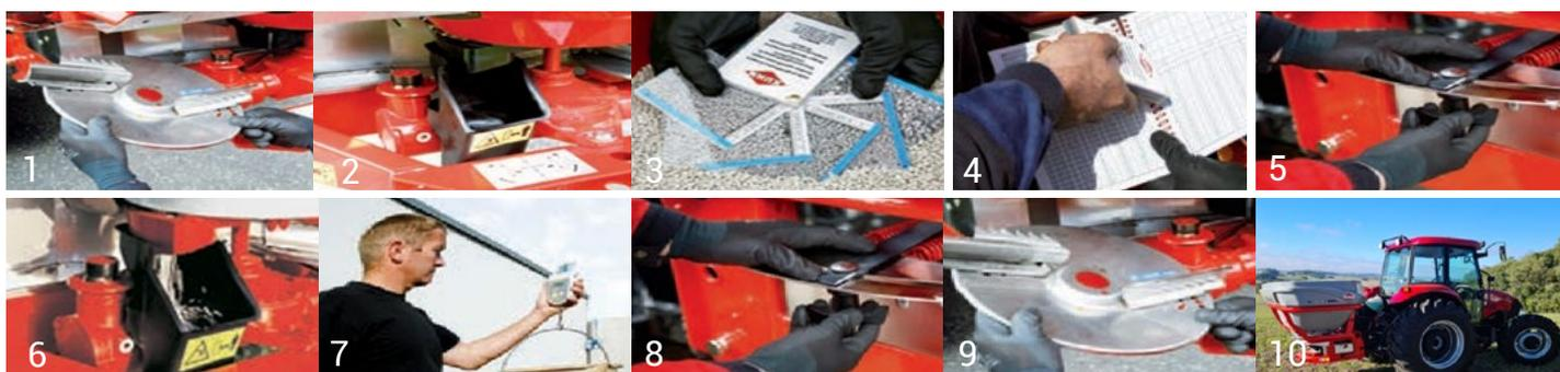
1. Remova o disco em alguns segundos. 2. Instale a guia. 3. Identifique o adubo com a guia de identificação/tabela de regulagem. 4. Determine a abertura de saída de acordo com as tabelas. 5. Defina a abertura de saída na máquina. 6. Abra a saída com o agitador em funcionamento. 7. Pese a quantidade coletada e use as tabelas para calcular a configuração exata. 8. Ajuste a abertura de saída para maior precisão de taxa. 9. Reinstale o disco. 10. Agora você está pronto para distribuir.
